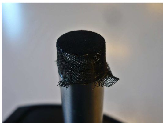
Sítka zanesené sazemí
